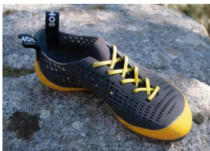
Abbildung 2: Sportschuh gedruckt im MJT-Verfahren
