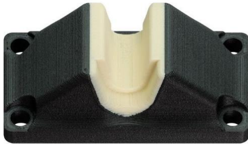
Abbildung 4: Multimaterialdruck mit dem FDM-Verfahren eines Lagerblocks
