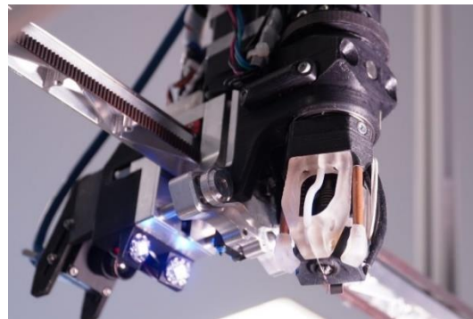
Abbildung 5: Druckkopf für das Legen von Metalldrähten und der gleichzeitigen Extrusion von thermoplastischen Polymeren
