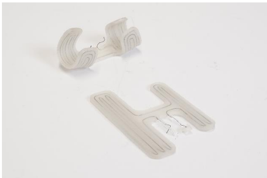
Abbildung 8: Druck einer Fingerorthese für eine individuelle Anpassung durch eine thermisch induzierte Phasenänderung
