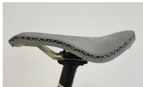
Abbildung 3: Variation von Eigenschaften bei einem Fahrradsattel (SLS- Verfahren)
