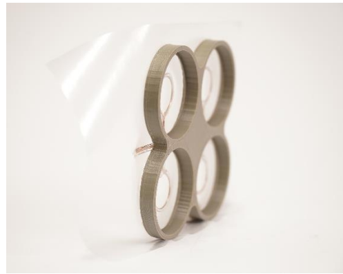
Abbildung 9 Lautsprecher als Multimateriasystem aus Kupfer /PC auf einer 100µm dicken TPU-Membran
