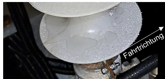
Abbildung 11 Hydrophobieigenschaften eines Referenzisolators in Abhängigkeit der Fahrtrichtung
