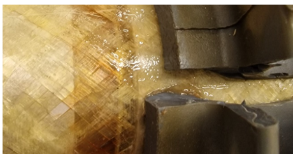
Abbildung 1: Wickelstruktur und Isolationsschicht ohne Haftung
