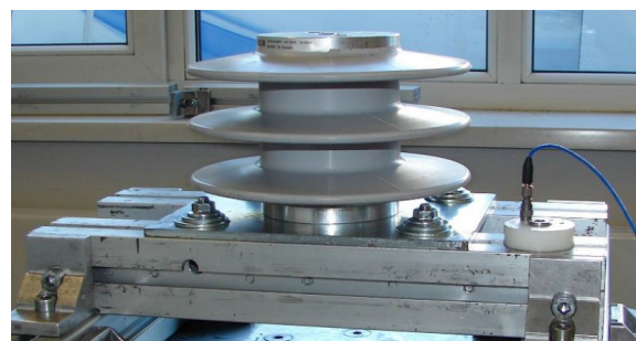
Abbildung 8: Prüfaufbau Shock and Vibration Test am SBKW-B DC-B
