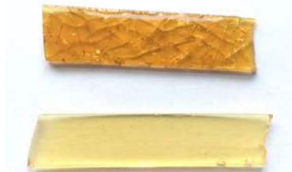
Abbildung 3: Harzproben nach siebentägiger Wasserlagerung (oben Acrylat, unten Epoxid)
