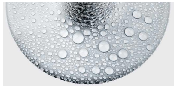
Abbildung 5: Tropfenbelag auf dem Schirm eines Kabel-Endverschlusses aus Siliconelastomer
