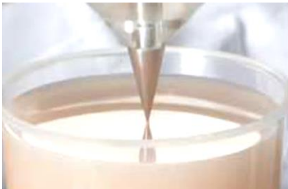
Abbildung 12: Beispiel einer Penetrometermessung an einem Silicongel
