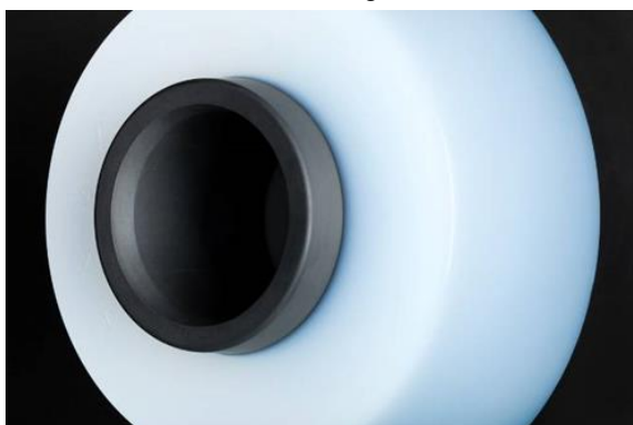
Abbildung 9: Hochspannungs-Kabelmuffe aus Siliconelastomeren; schwarz: Steuererteil und äußere leitfähige Beschichtung, weiß: Isoliermaterial
